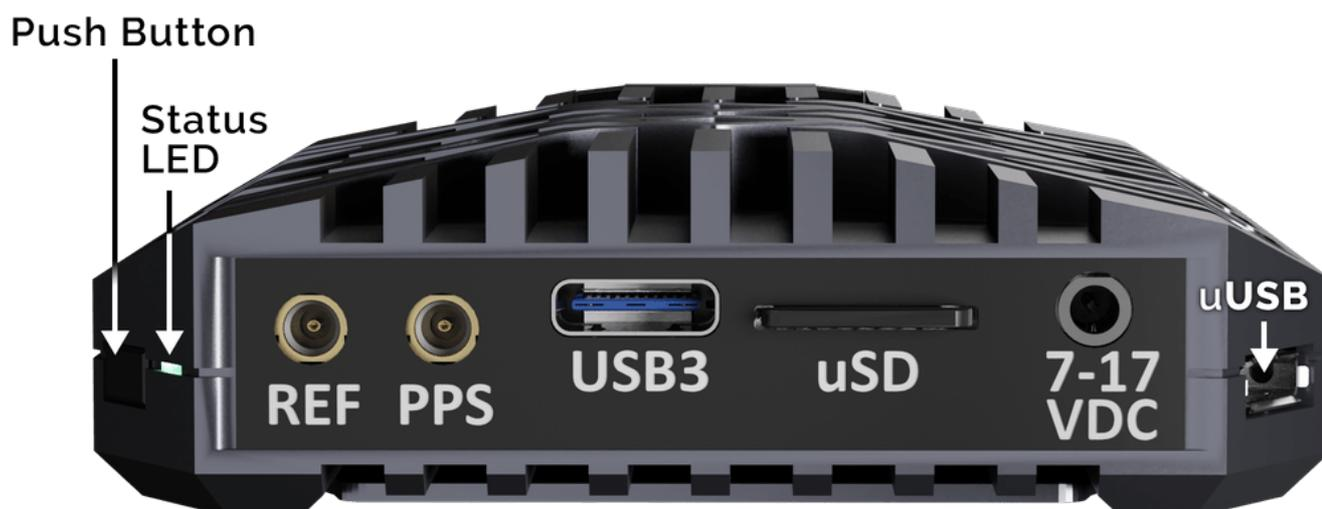
**Figure 2:** Matchstiq Z3u rear I/O ports
